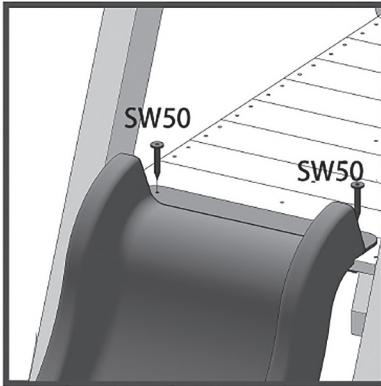
**CZ** Umístěte díl T1 pod podlahu, aby se zabránilo vypadnutí šroubu. / **SK** Umiestnite diel T1 pod podlahu, aby sa zabránilo vypadnutiu skrutky. / **EN** Put T1 under the floor to prevent the screw from falling off. / **DE** Platzieren Sie das Teil T1 unter dem Boden, um ein Herausfallen der Schraube zu verhindern.
